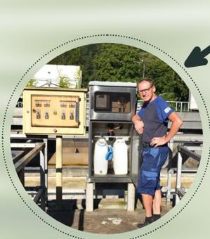
Auf den verschiedenen Stationen der Kläranlage werden teils automatisch, teils händisch über den Tag verteilt, Proben entnommen und im hauseigenen Labor untersucht. Die Messergebnisse sind für die Anlagensteuerung notwendig und werden auch gegenüber der Behörde dokumentiert. Zusätzlich gehen Proben an ein akkreditiertes Prüflabor, welches die Einhaltung der vorgeschriebenen Grenzwerte und die Reinigungsleistung der Kläranlage überwacht.
